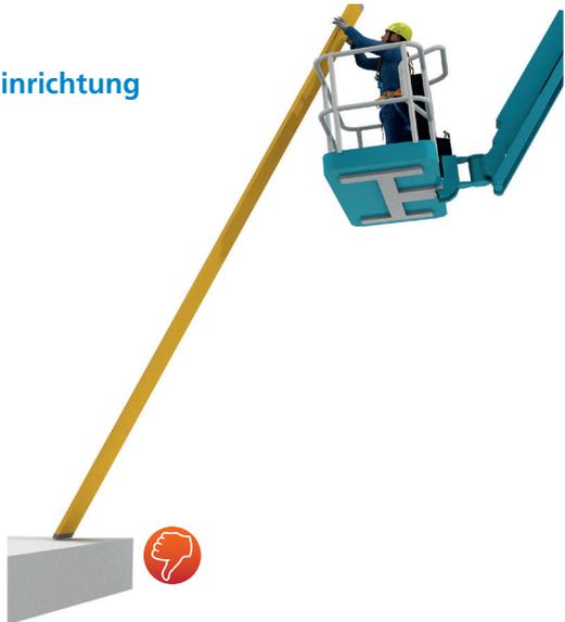
Genau so ist es verboten, den Ausleger bzw. die Arbeitsbühne (Korb) zwecks Stabilisierung an Bauteilen oder Gebäuden abzustützen oder anzulehnen. Durch die auftretenden Kräfte kann die Korblastsicherung oder auch die eventuell vorhandene Lastmomentbegrenzung ansprechen. Eine weitere Betätigung ist erst nach Entfernung der Last möglich. Auch dadurch kann ein Katapulteffekt entstehen. Die Lasten können die FHAB zum Umstürzen bringen.
