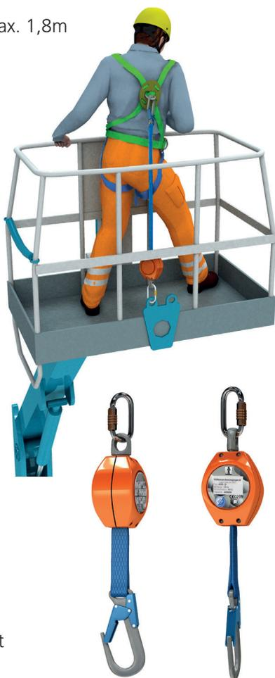
Nicht empfohlen werden Höhensicherungsgeräte mit Bandfalldämpfer, weil sie im Ernstfall das Sicherungssystem stark verlängern und dadurch die gesicherte Person aus dem Korb geschleudert werden kann.
